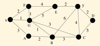
Pour le graphe  $G_5$  ci-dessus, utiliser l'algorithme de DIJKSTRA pour trouver les distances d(x,a) pour  $a \in G_5$ . En particulier, déterminer une chaîne de poids minimum reliant x à y.
